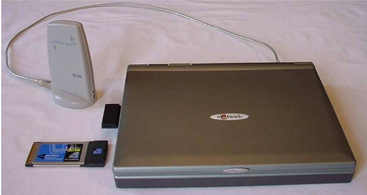
**Abb. 3:** Beispiele für WLAN PC-Cards (vorne links und seitlich im Notebook) sowie WLAN USB-Terminal-Adapter (hinten)
